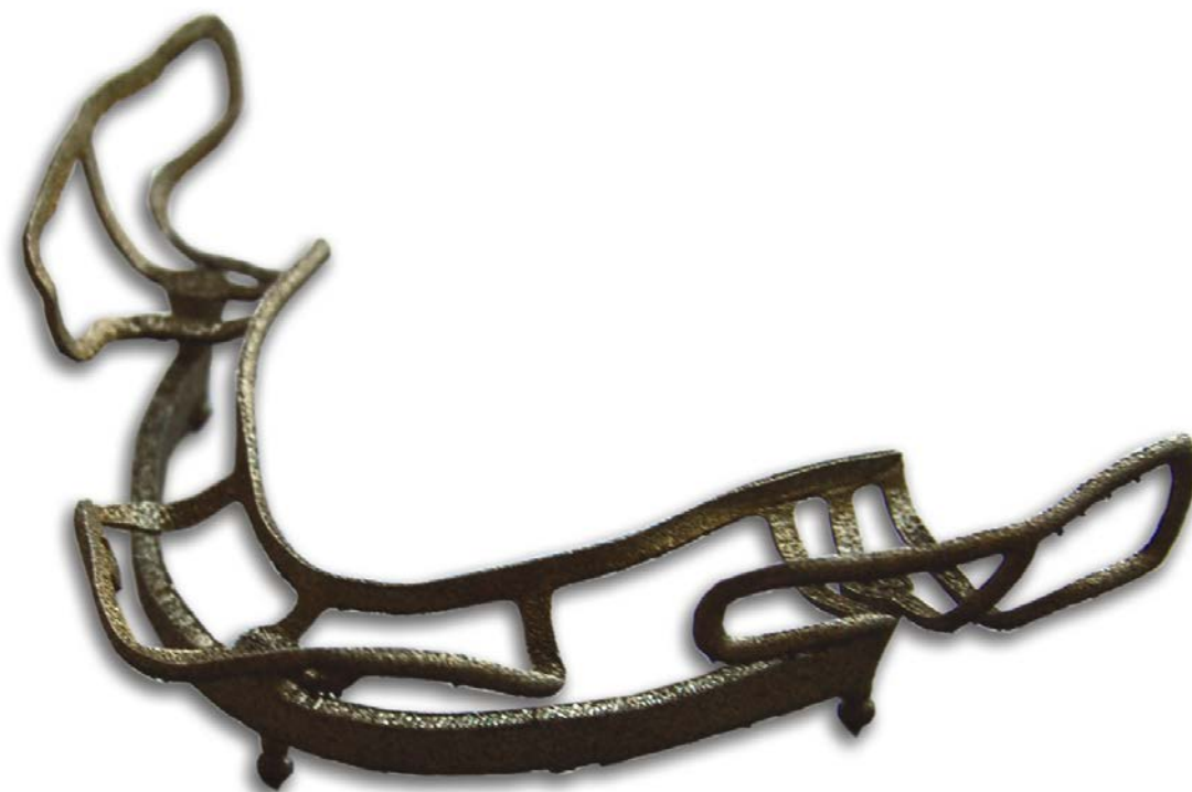
Изработен на машината SLM 125HL субпериостален имплант
