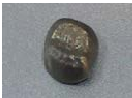
Изработеният на машината SLM 125HL модел с поддържащия материал и моделът след финална обработка
